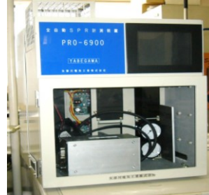
SPRイムノアッセイ計測装置 (PRO-6920)
