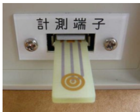
電気化学バイオセンサチップ 3.5cm × 1.2cm
